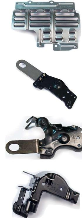
Mampara de separación del motor del habitáculo de pasajeros, diferentes piezas de soporte y sujeción del motor, soportes para piezas del motor, el protector del filtro de aceite y el de gasoil.
